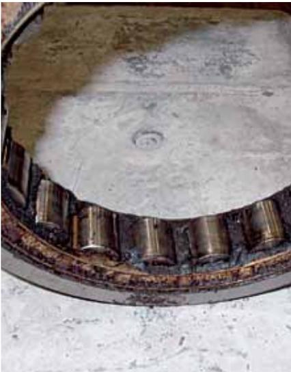
**Figura: Grasa del rodamiento quemada**
