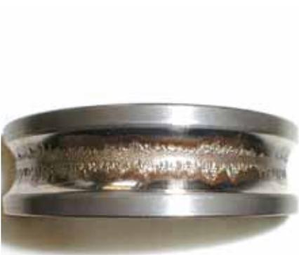
**Figura: Camino de rodadura dañado**
