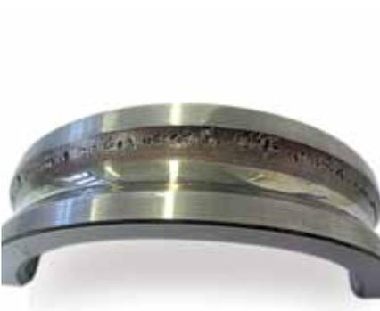
**Figura: Camino de rodadura por fuera de ruta normal**
