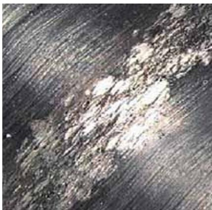
**Figura: Camino de rodadura rayado (especialmente para rodamientos de rodillos cilíndricos)**
