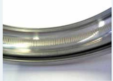
Camino de rodadura externo con presencia de marcación.
