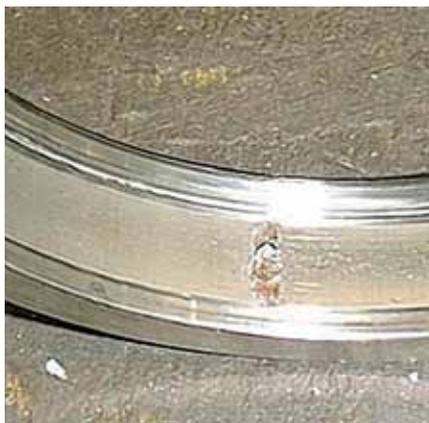
**Figura: Astillado en zona de carga del camino de rodadura externo**
