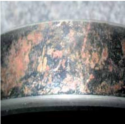
**Figura: Micro corrosión sobre el anillo exterior**
